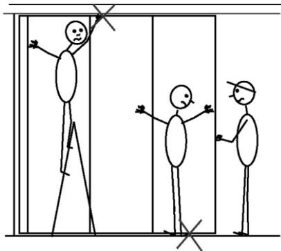
Am Boden- und Deckenanschluss werden bei Betätigung der Druckschalter (schließen) Druckbalken ausgefahren. Bitte achten Sie darauf, dass sich weder Fußspitzen noch Finger im Pressbereich der Druckbalken befinden. Verletzungsgefahr!
